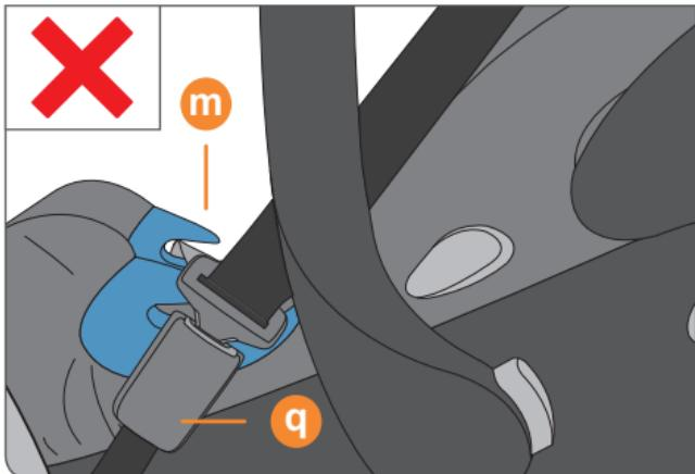
**FIGYELEM!** A CYBEX Aton Q kizárolag menetiránnyal azonosan beszerelt autós ülésekhez készült, amelyek 3-pontos biztonsági övrendszerrel vannak felszerelve az ECE R16-nak megfelelően.
